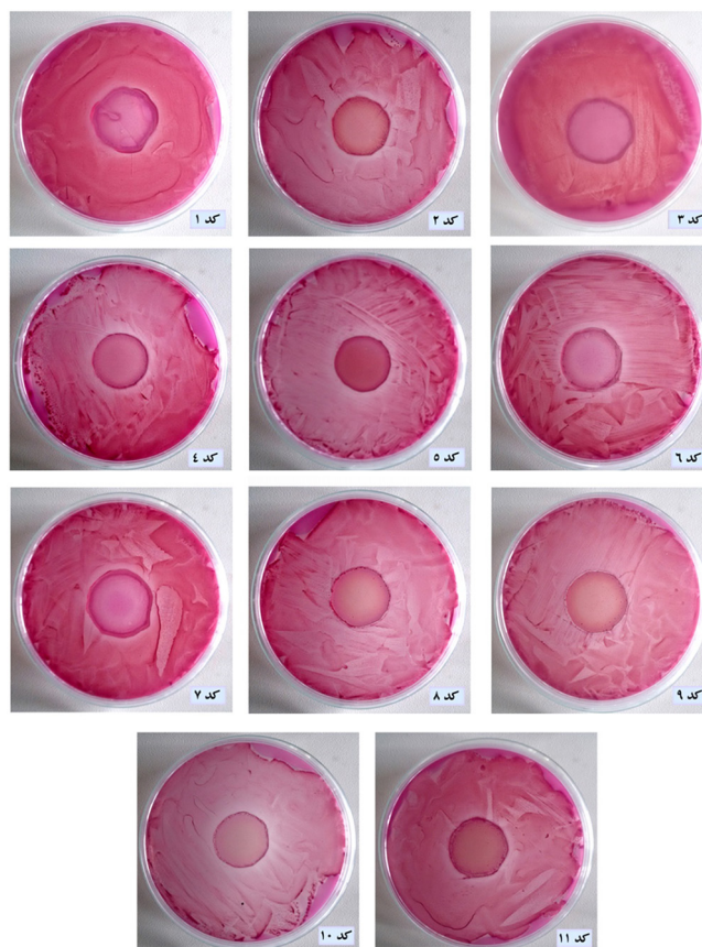
شکل ۱۰- تصاویر ناحیه بازدارنده انواع فیلم‌های نانوزیست کامپوزیت علیه باکتری /شرشیاکلی (کدها در تصاویر مطابق جدول ۱ است).
