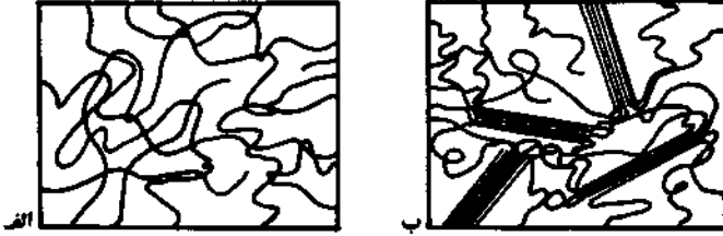
شکل ۳ - امکان آرایش مولکولهای پلی مرها به صورت (الف) آمورف (ب) - نیمه بلوری
