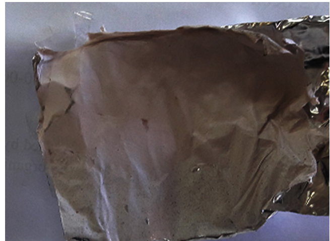
شکل ۵- نانوالیاف \{\text{Mo}_{132}\} -PAN حاصل از فرایند الکتروریسی روی ورق آلومینیم.
