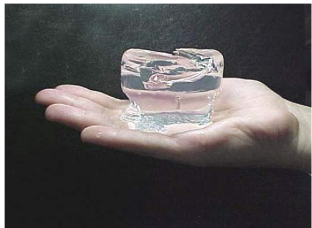
شکل ۸- ابرجاذب هیبریدی متورم‌شده در آب بر پایه صمغ عربی، آکرلیک اسید و آکریل آمید [۴۲].
