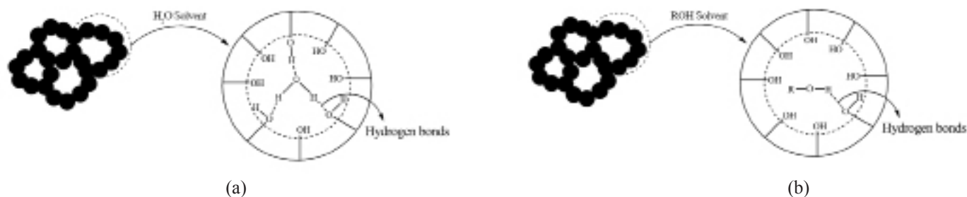
شکل ۲- برهم‌کنش آب و حلال‌های الکلی داخل حفره‌ها با گروه‌های سیلانولی موجود در سطح داخلی حفره‌ها.
