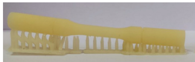
شکل ۱- (a) مشخصات ابعادی نمونه خستگی و (b) نمونه چاپ شده همراه با پایه.
