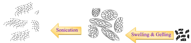
طرح ۱- تورم هیدروژل هنگام ژله‌ای شدن و تخریب آن در اثر تابش فراصوت.
