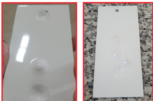
شکل ۵- ورق فلزی پوشش‌یافته با پوشش پودری حاصل از رزین پلی‌استر TMA-free-1.5.
