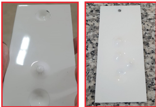
شکل ۵- ورق فلزی پوشش‌یافته با پوشش پودری حاصل از رزین پلی‌استر TMA-free-1.5.
