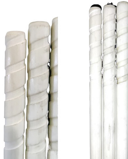
شکل ۱۶- میلگردهای کامپوزیتی با هندسه بهینه‌شده آج‌ها. Fig. 16. Composite rebars with optimized rib geometry.
