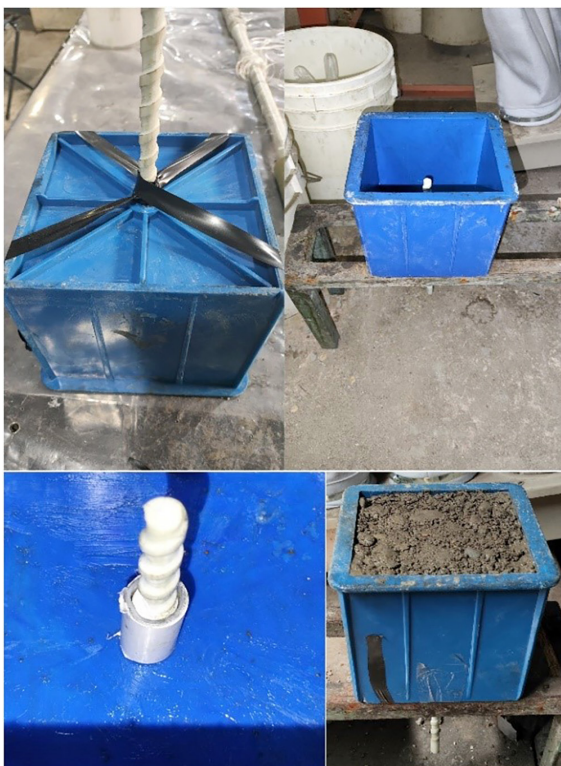
شکل ۲- فرایند آماده‌سازی نمونه‌های آزمایش بیرون‌کشیدگی.
