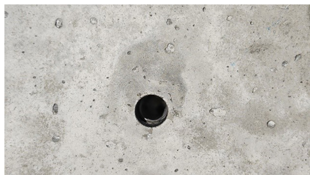
شکل ۱۱- حفره باقی‌مانده از قرارگیری میلگرد کامپوزیتی در نمونه کنترل، پس از انجام آزمایش و خارج‌سازی میلگرد از بلوک بتنی.
