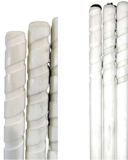
شکل ۱۶- میلگردهای کامپوزیتی با هندسه بهینه‌شده آج‌ها. Fig. 16. Composite rebars with optimized rib geometry.
