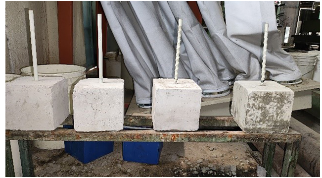
شکل ۳- نمونه‌های آزمایش بیرون‌کشیدگی.
