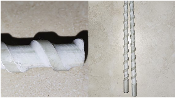
شکل ۱- نمونه‌هایی از میلگردهای ماشین‌کاری‌شده.
