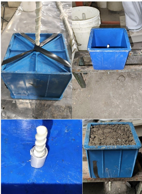
شکل ۲- فرایند آماده‌سازی نمونه‌های آزمایش بیرون‌کشیدگی.
