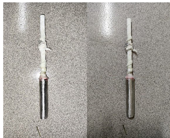
شکل ۱۳- میلگرد کامپوزیتی پس از پایان آزمایش بیرون‌کشیدگی. Fig. 13. Composite rebar following the completion of the pull-out test.
