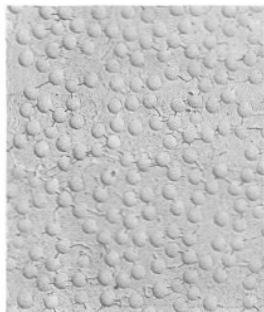
شکل ۲- تشکیل پلهای پلیمری بین ذرات سرامیک و نقش محملهای پلیمری [۴].
