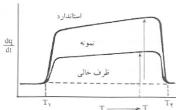
شکل ۱ - محاسبه ظرفیت گرمایی با استفاده از DSC.
