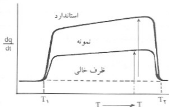
شکل ۱ - محاسبه ظرفیت گرمایی با استفاده از DSC.
