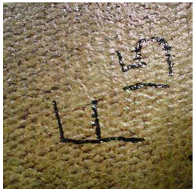
شکل ۲- نمونه‌ای از کامپوزیت فنولی - پنبه‌نسوز ساخته شده.
