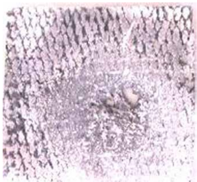
شکل ۸- نمونه کامپوزیت پس از آزمون شعله اکسی استیلن.
