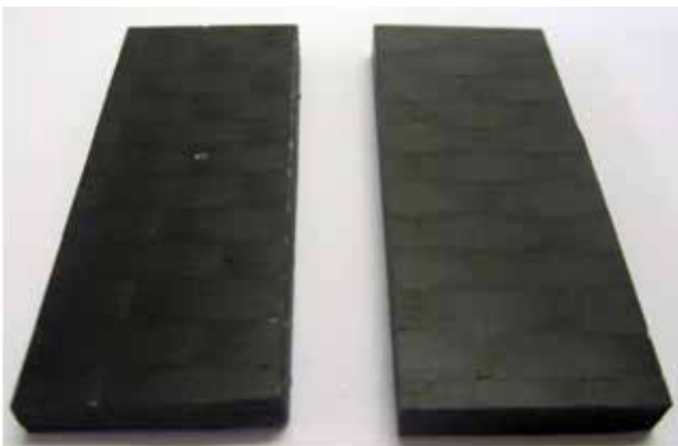
شکل ۱۴ - قطعات کامپوزیتی ساخته‌شده برای آزمون شیارزنی.
