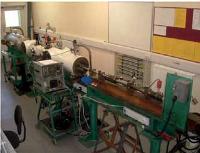
شکل ۳- دستگاه آزمون تفنگ گازی [۳۵].
