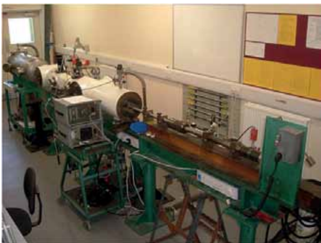
شکل ۳- دستگاه آزمون تفنگ گازی [۳۵].
