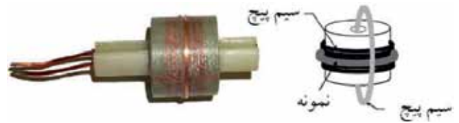
شکل ۵- دستگاه آزمون حلقه انبساطی [۴۵،۴۶].
