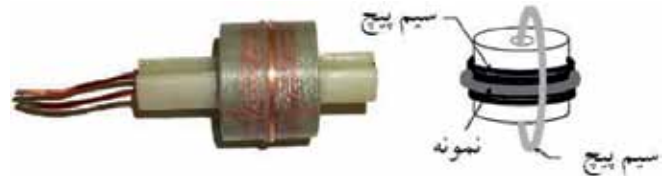
شکل ۵- دستگاه آزمون حلقه انبساطی [۴۵،۴۶].
