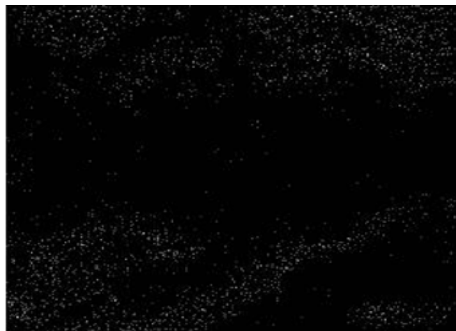
شکل ۲- تصویر نقشه عنصری سدیم (Na Map) از سطح نمونه پلی‌آکریل‌آمید آنیونی با ۳۰ درصد آب‌کافت.
