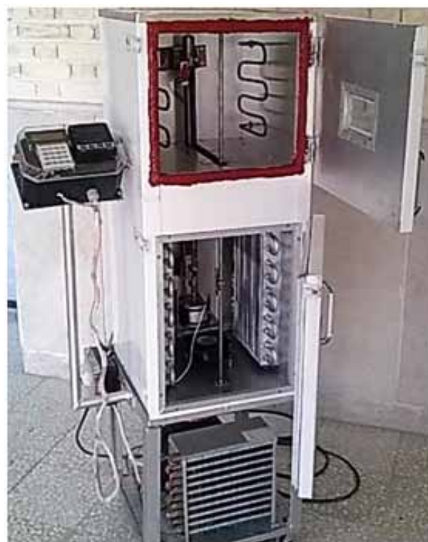
شکل ۳- نمای کلی از دستگاه بارگذاری گرمایی چرخه‌ای.
