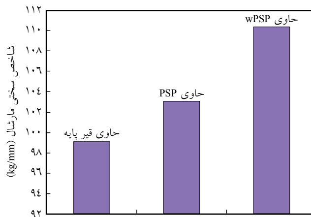
شکل ۲- نسبت مارشال نمونه‌های آسفالتی.
