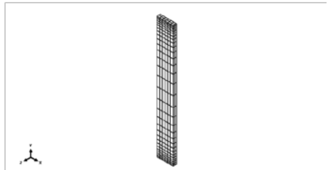
شکل ۳- شبکه اجزای محدود نمونه ۱ cm ساخته شده از اجزای شش‌وجهی ۲۰-گره‌ای هیبریدی.
