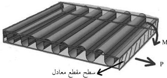
شکل ۵- اعمال بارگذاری به ورق موج‌دار.
