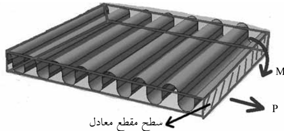
شکل ۵- اعمال بارگذاری به ورق موج‌دار.
