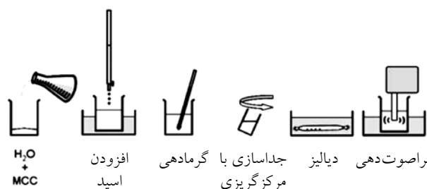
شکل ۱- طرح کلی برای تهیه نانوبلور سلولوز از میکروبلور سلولوز.
