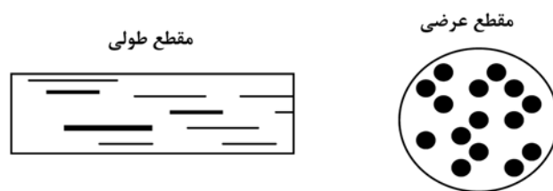
شکل ۳ - طرح کلی از مقاطع طولی و عرضی الیاف آمیخته با ساختار ماتریس - لیفچه.
