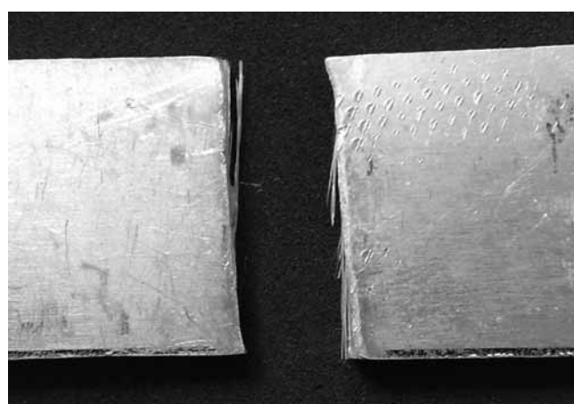
شکل ۳ - تصویر شکست نمونه B پس از انجام آزمون کشش.
