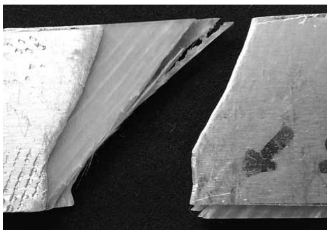
شکل ۵ - تصویر شکست نمونه E پس از انجام آزمون کشش.
