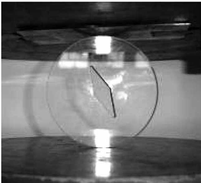
شکل ۵ - نمایی از نمونه RV-BD به هنگام آزمایش شکست شیوه II خالص.
