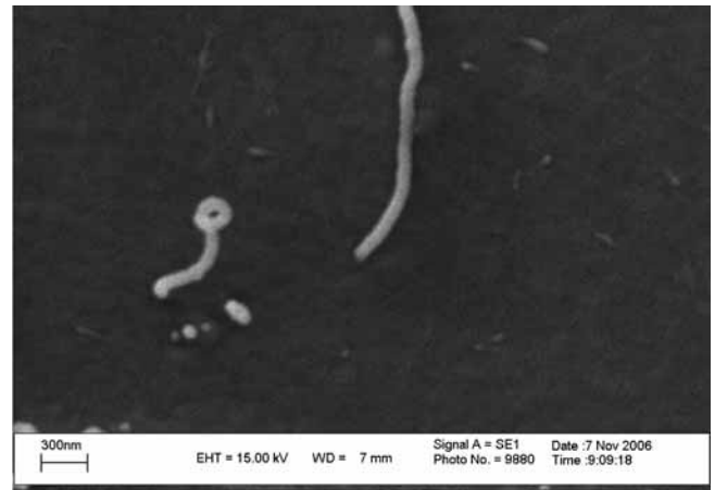
شکل ۱۳ - تصویر SEM از پیوند فصل مشترک نانولوله‌های کربنی با زمینه اپوکسی در نانوکامپوزیت EP9/0.6CNT.
