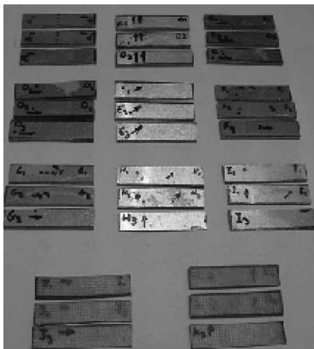
شکل ۳ - نمونه‌های کوتاه آزمون ضربه پیش از انجام آزمایش.
