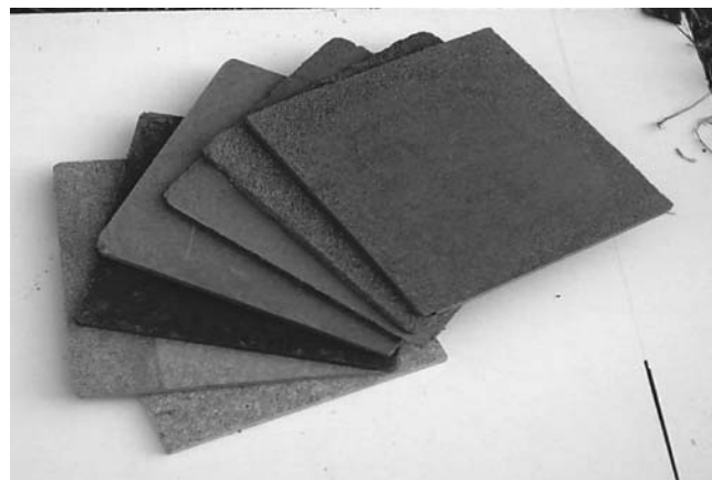
شکل ۱- چند نمونه از تخته‌های چوب-پلاستیک به ابعاد ۱۳۳۵×۳۵ cm.
