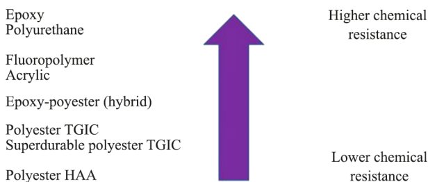
شکل ۱۴- مقایسه مقاومت شیمیایی پوشش‌های پودری حاصل از رزین‌های مختلف.
