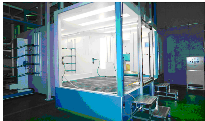
شکل ۱۶- محفظه ابری الکتروستاتیک برای اعمال و افشانش پوشش پودری با بهره‌وری زیاد [۸۲].
