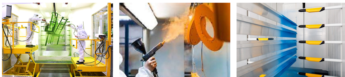
شکل ۵- نحوه اعمال پوشش پودری الکتروستاتیک [۲۳].
