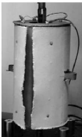
شکل ۵ کوره فلزی عایق بندی شده برای کشش گرم.
