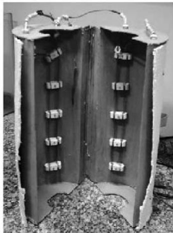
شکل ۵ کوره فلزی عایق بندی شده برای کشش گرم.
