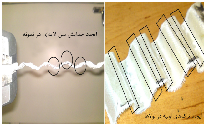
شکل ۲۲- برخی از عیوب ایجاد شده در نمونه موج‌دار زیر بار کششی.
