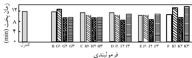
شکل ۲- اثر فرمولبندی، نوع و مقدار عوامل جفت کننده بر زمان پخت آمیزه ها: (□) کنترل، (■) سیلان، (▲) HVA-۲ و (⊠) رنوفیت.
