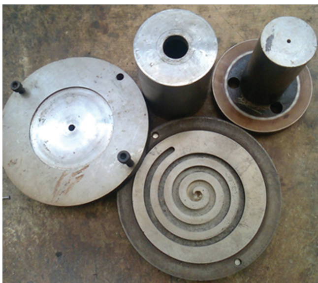
شکل ۳- قالب مارپیچ برای اندازه‌گیری مقدار جریان یافتگی آمیزه قالب‌گیری.
