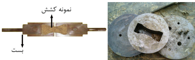
شکل ۲- قالب نمونه‌های کشش و بست و نگهداری آن هنگام کشش.
