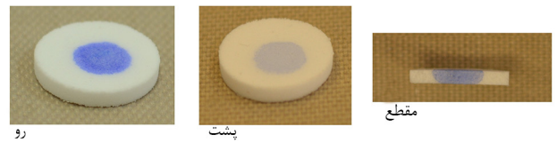
شکل ۸- آزمون تراوایی قطره استون برای نمونه R.
