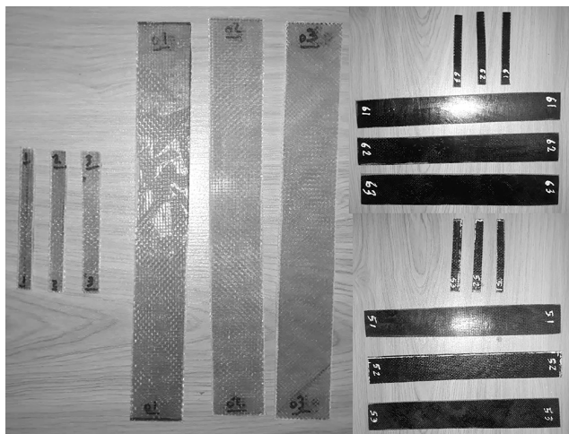
شکل ۴- نمایی از نمونه‌سازی کامپوزیت الیاف شیشه-اپوکسی تقویت‌شده در آزمون کشش و خمش.
