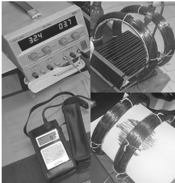
شکل ۱- تصویری از (a) شدت میدان اندازه‌گیری شده (b) کاوند اندازه‌گیری میدان در دستگاه (c) آزمون میدان با براده‌های آهن. Fig. 1. An image of: (a) the measured magnetic field intensity, (b) the magnetic field measurement probe inside the device, (c) field testing using iron filings.
