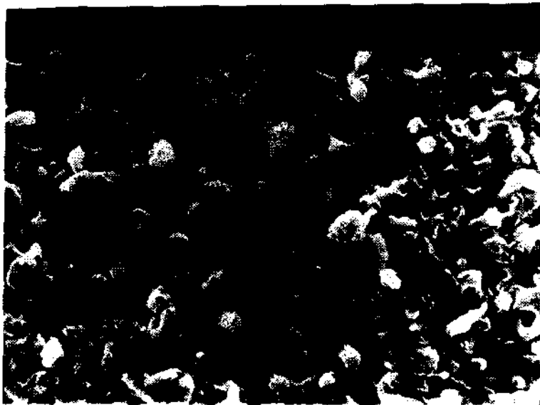
شکل ۶ تصویر میکروسکوپ الکترون پوشی آلیاز PP/HDPE به نسبت ۸۰/۲۰ که این آلیاز با ۲ درصد EPDM اصلاح شده است.
