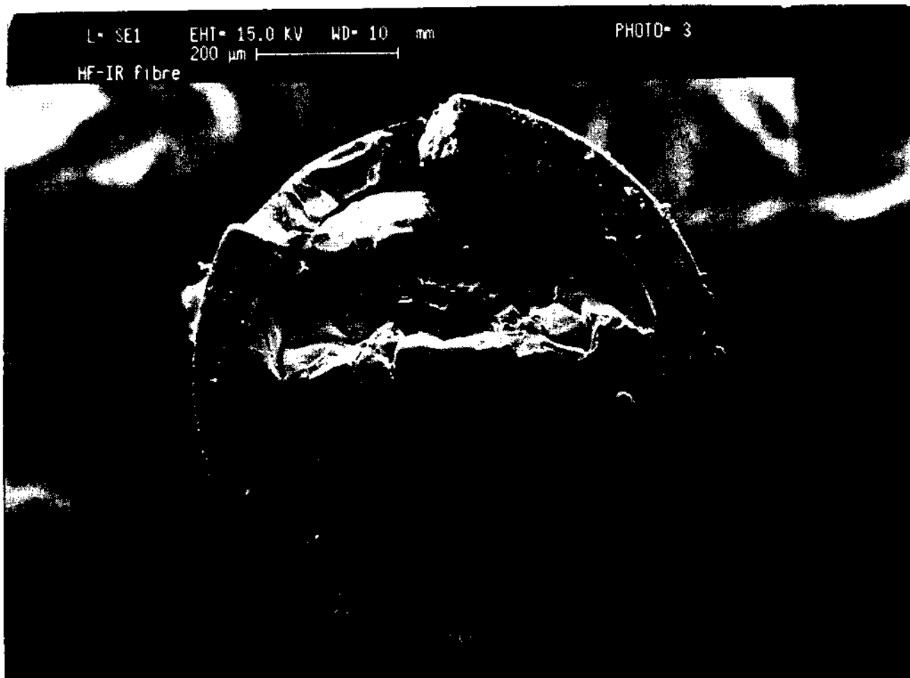
شکل ۱۳- نمونه‌ای از آسیب‌دیدگی تار شیشه فلوئورید 500 \mu\text{m} در شاردگی زیاد در تماس با بافت.
