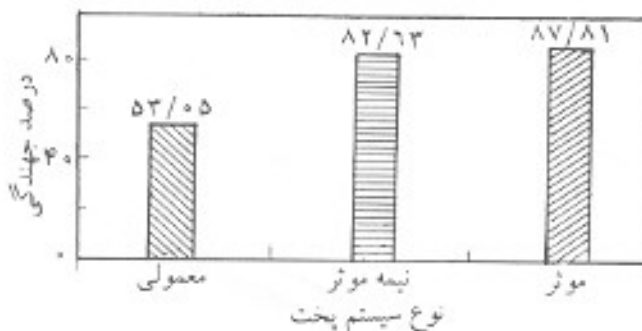
شکل ۵- اثر نوع سیستم پخت گاوگردی بر میزان جهنگی آمیزه پخت شده.
